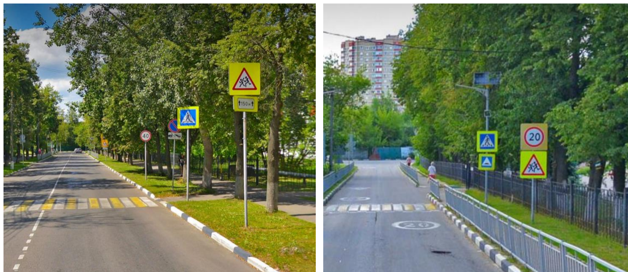
Рисунок 2.20 – Примеры успокоения трафика путем установления ступенчатого понижения скорости и искусственных неровностей
